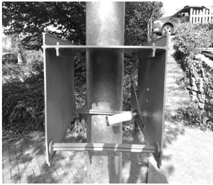
Abbildung 3: Außenluft-Passivsammler für Quecksilber im Shelter
